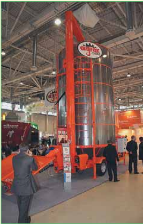
Мобильная зерносушилка PRT 250 ME от компании Agrex предназначена для сушки различных видов зерновых. Ее производительность – от 75 до 270 т/сутки в зависимости от вида высушиваемого продукта, начальной влажности и погодных условий.
