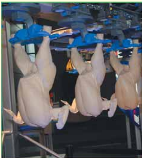
Если раньше тушки птиц ошпаривали водой с высоким содержанием воздуха, то система AeroScalder обрабатывает птицу воздухом с высоким содержанием воды, благодаря чему сокращаются затраты и процесс становится более гигиеничным
