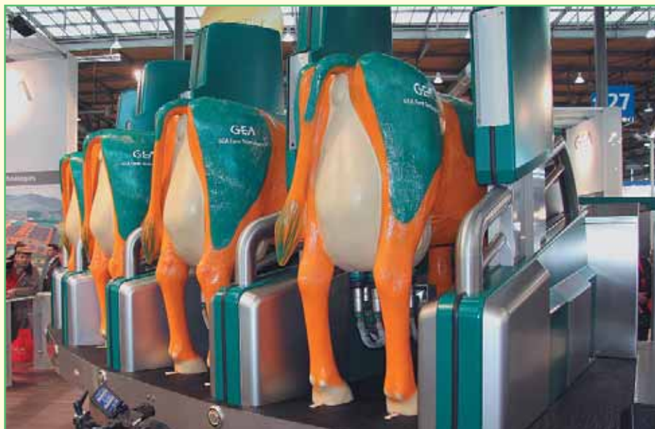
Узкий модуль GEA DairyProQ позволяет внедрить автоматическое или полуавтоматическое доение при любых уже имеющихся в хозяйстве доильных системах – карусель, тандем, елочка или параллель
