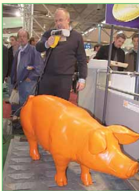
Примерно так происходит определение массы свиньи с помощью прибора optiSCAN , созданного немецкой компанией Hölscher + Leuschner и получившего золото EuroTier-2012
