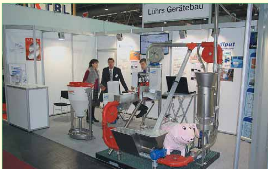
Кольцевая система для однотрубных установок сухого кормления Eberstich компании Lührs
