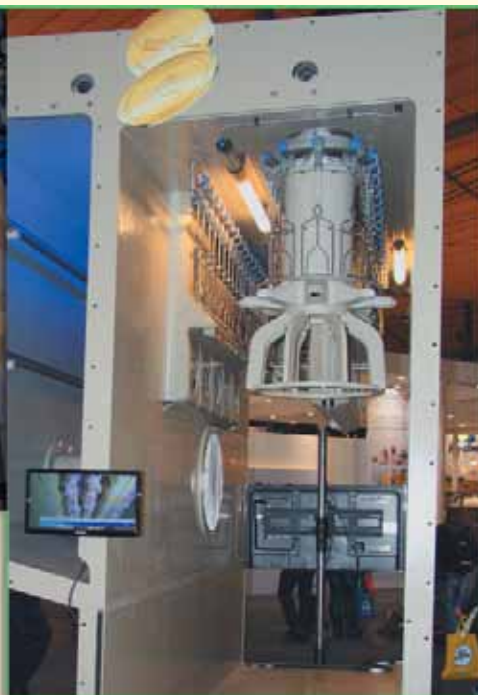
Если раньше тушки птиц ошпаривали водой с высоким содержанием воздуха, то система AeroScalder обрабатывает птицу воздухом с высоким содержанием воды, благодаря чему сокращаются затраты и процесс становится более гигиеничным
