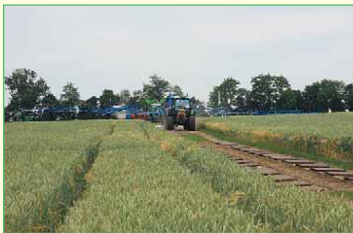
Опрыскиватели, преодолевая искусственно созданные неровности на поле, должны были тем не менее сохранять штанги в максимально стабильном и ровном положении. Не всегда у всех это получалось хорошо.
