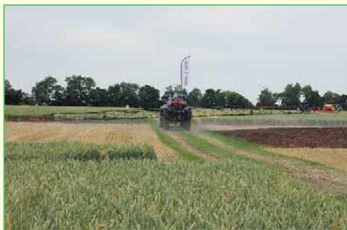
Опрыскиватели, преодолевая искусственно созданные неровности на поле, должны были тем не менее сохранять штанги в максимально стабильном и ровном положении. Не всегда у всех это получалось хорошо.
