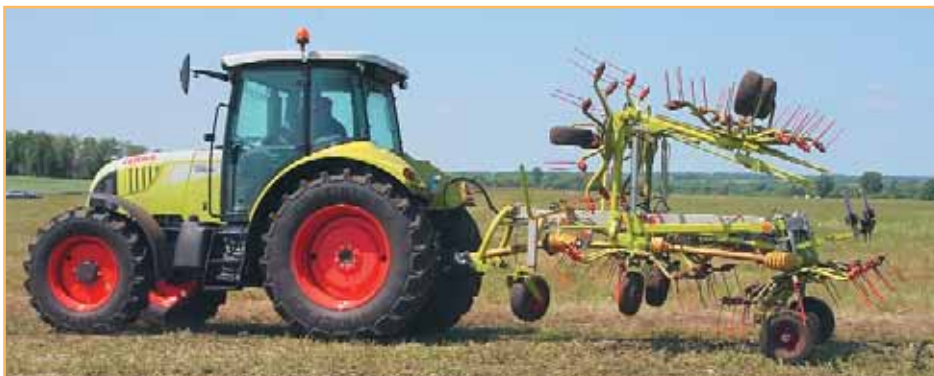
При перевозке ширина и высота ворошилки Volto 1050 T составляет 2,9 м, длина — 4,2 м
