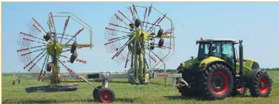
Liner 3500 имеет четырехколесную базу, раздельную систему электрогидравлического подъема и снабжен 4 роторами, на каждом из которых установлено 12 граблин
