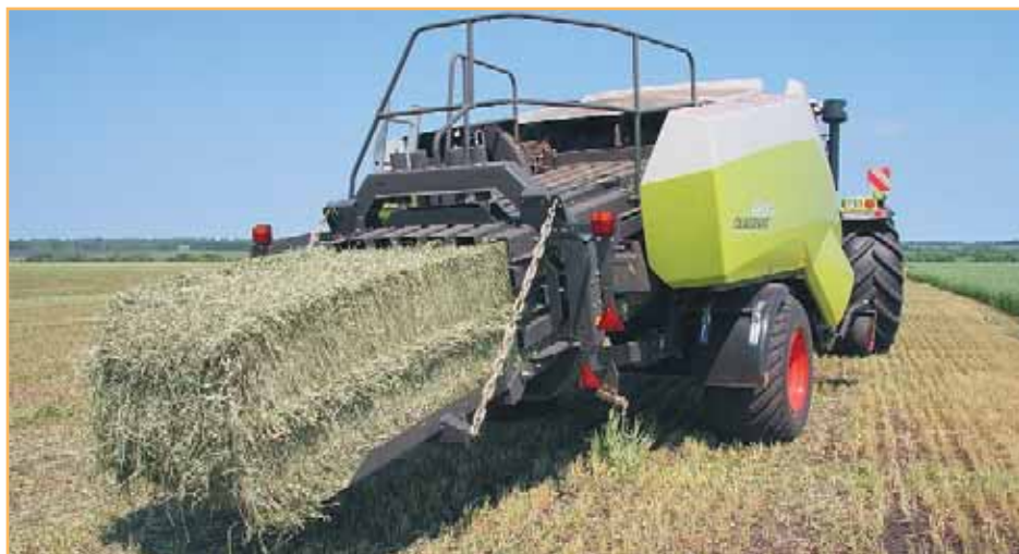
Quadrant 3200 FC формирует тюки форматом 1,2x0,7 м и длиной от 0,5 до 3 м
