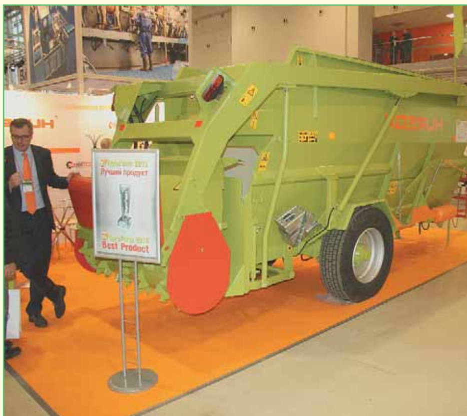
Фото 6. Одноосный разбрасыватель твердых органических удобрений РОУМ-14 от компании «Интенсивные технологии»
