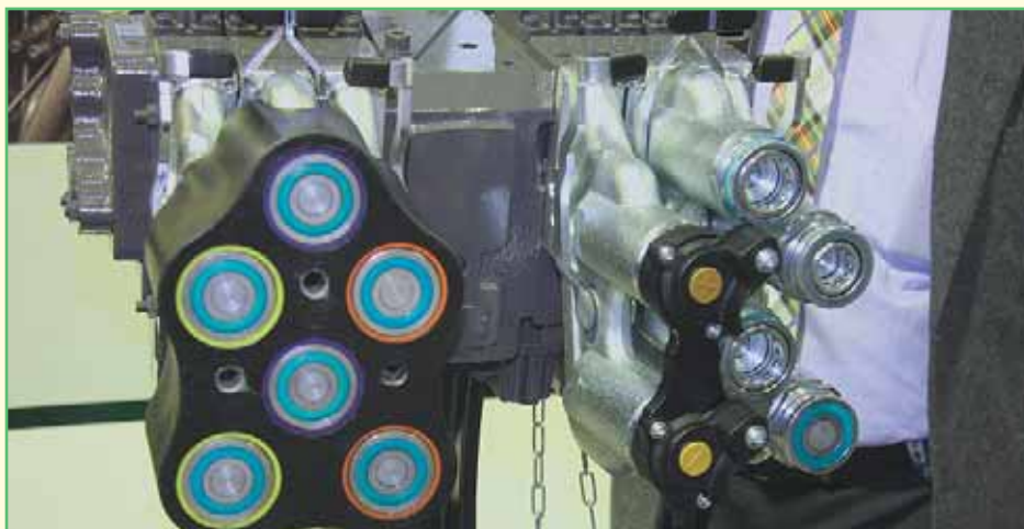
Фото 11. Сменные гидравлические соединительные муфты от Fendt
