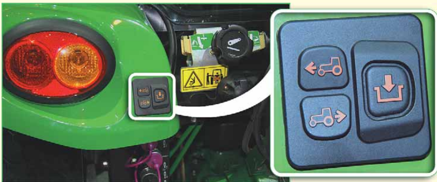
Фото 6. Система John Deere Hitch Assist позволяет с помощью кнопок перемещать сцепку трактора и не сидеть при этом в кабине
