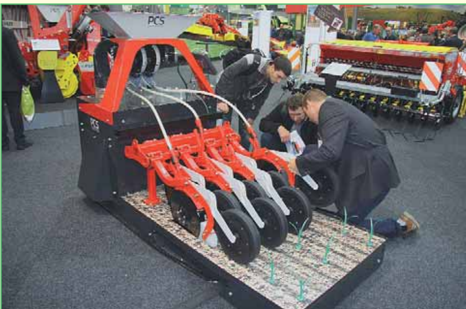
Фото 10. Концепция прецизионной комбинированной сеялки (PCS – Precision Combiseeding) от Pöttinger, которую можно использовать для решения четырех задач: посева зерновых, посева кукурузы с удобрением или без, посева кукурузы с подсевными культурами
