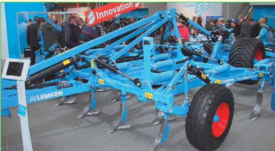
Фото 9. Полунавесной культиватор от LEMKEN с системой регулирования глубины обработки почвы в условиях сильно пересеченной местности
