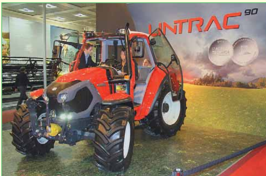
Фото 12. Трактор LINTRAC 90 с управляемой задней осью от австрийской компании Lindner
