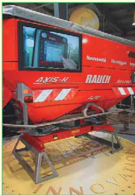
Фото 2. Распределитель удобрений компании RAUCH с системой АХМАТ – первой в мире полностью автоматизированной установкой для онлайн-оценки распределения удобрений
