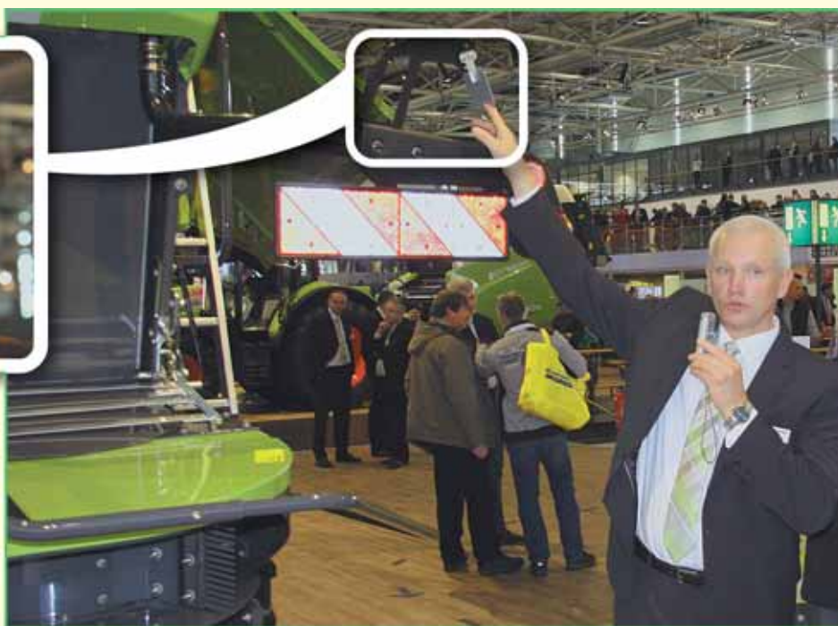
Фото 5. Датчик ветра и уклона на зерноуборочных комбайнах LEXION с радиальным разбрасывателем
