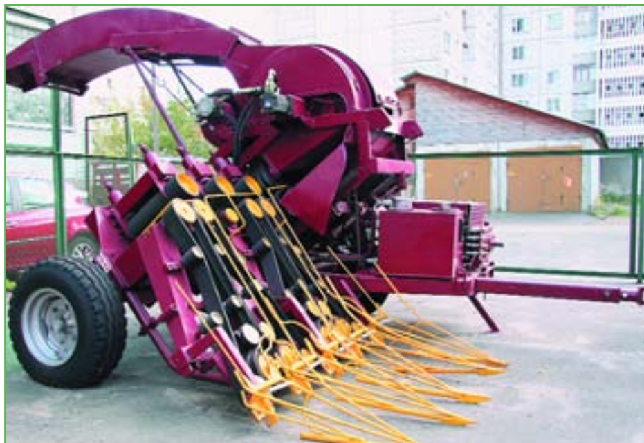
Комбайн льноуборочный гидрофицированный ГЛК-01. Разработчики: ВНИПТИМЛ и ОАО «Тверьсельмаш»
