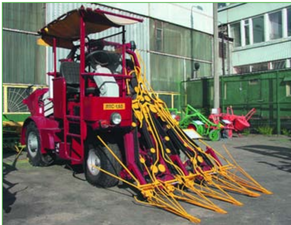
Фронтальная самоходная льнотеребилка ЛТС-1,65. Разработчики: ВНИПТИМЛ и ОАО «Тверьсельмаш»
