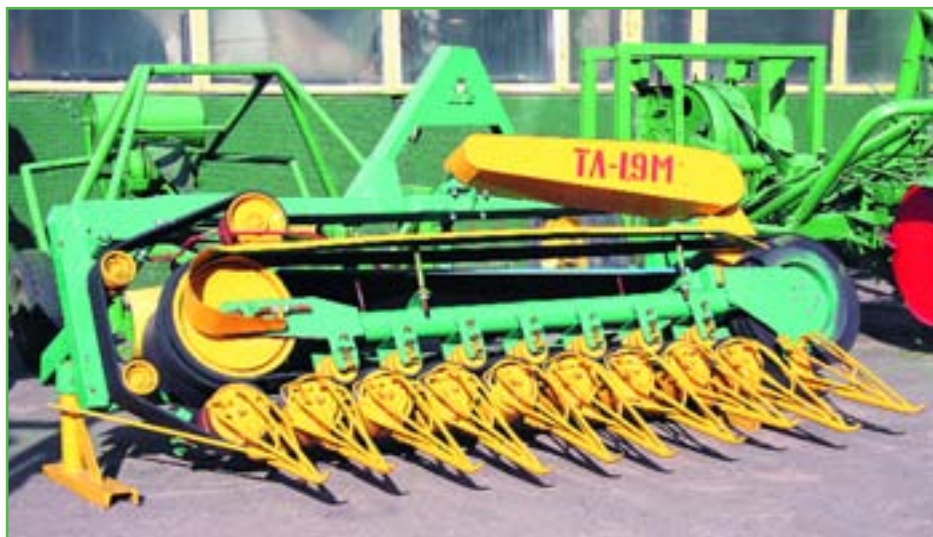
Фронтальная теребилка ТЛ-1,9 М. Разработчик и изготовитель ВНИПТИМЛ
