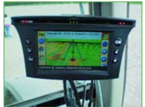
Фото 1. Навигационный прибор EZ-Guide 500 Lightbar для системы «Автопилот»
