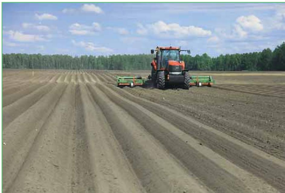
С помощью современной системы навигации рядки под картофель получаются ровными с точностью до 2 см
