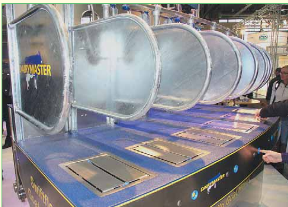
Фото 3. Выставочный фрагмент доильной карусели для коз Swiftflo Goat Rotary
