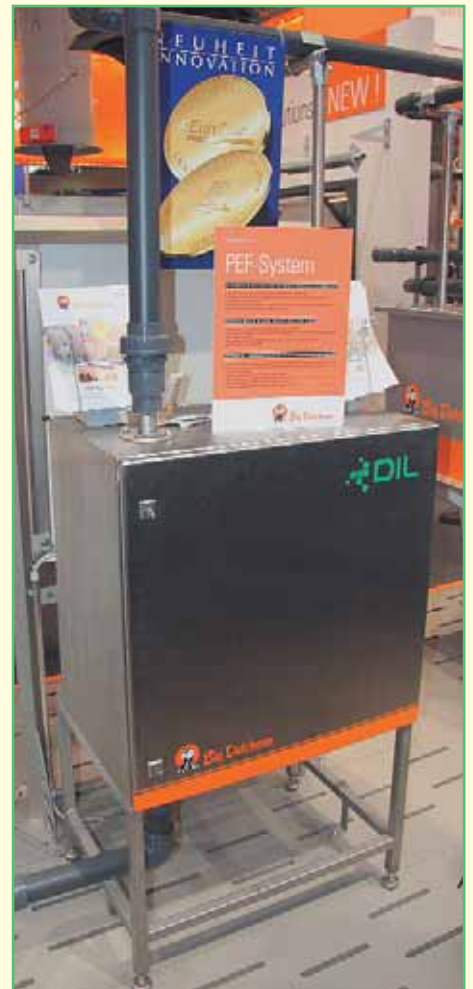
Фото 1. Система гомогенизации цельных растений кукурузы PEF-System компании Big Dutchman
