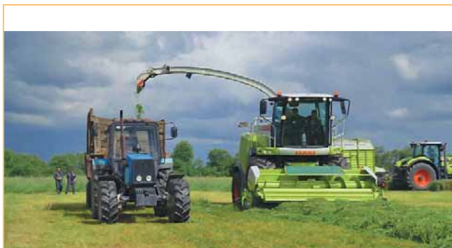
Кормоуборочный комбайн Jaguar 950 с увеличенным на 28% загрузочным сечением, оснащенный детекторами обнаружения металла и камней, а также системой телеметрии CLAAS Telematics
