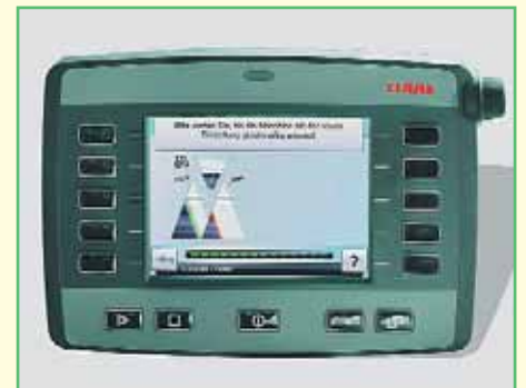
Монитор системы CEMOS, устанавливаемый на комбайны CLAAS Lexion и позволяющий автоматически настроить оптимальное соотношение производительности и качества работы комбайна
