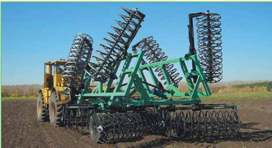
Борона «Лидер-БК» от «Сибирского агропромышленного дома», удаляющая сорняки из почвы вместе с корневой системой без подрезания
