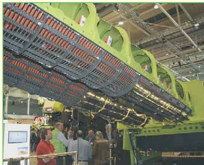
Система зерноочистки 4D для гибридных комбайнов, обеспечивающая высокую производительность гибридных комбайнов при работе на холмистых полях
