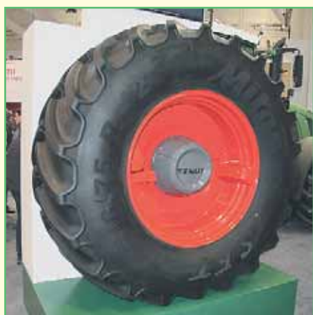
В этом колесе установлена система Fendt VarioGrip Pro, позволяющая поднять давление в шине с 0,8 бар до 1,8 бар за 30 секунд
