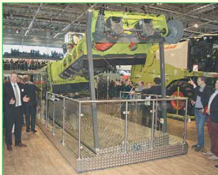
Система зерноочистки 4D для гибридных комбайнов, обеспечивающая высокую производительность гибридных комбайнов при работе на холмистых полях
