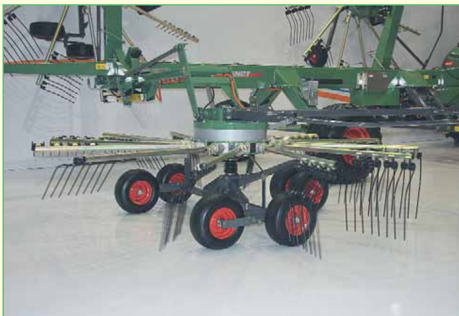
Первый компактный электропривод ротора Fendt Former 12555X
