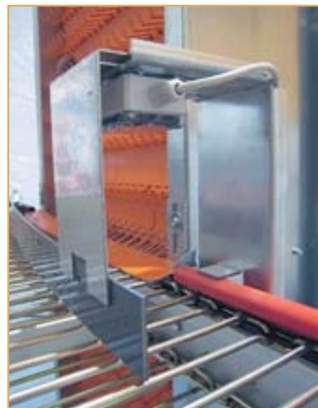
Рисунок. 2. Установка счетчика на транспортере яйцесбора.
