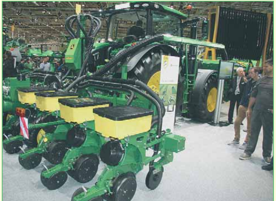
Сеялка от John Deere с системой ExactEmerge на первом в мире самообучающемся тракторе (iTEC AutoLearn)
