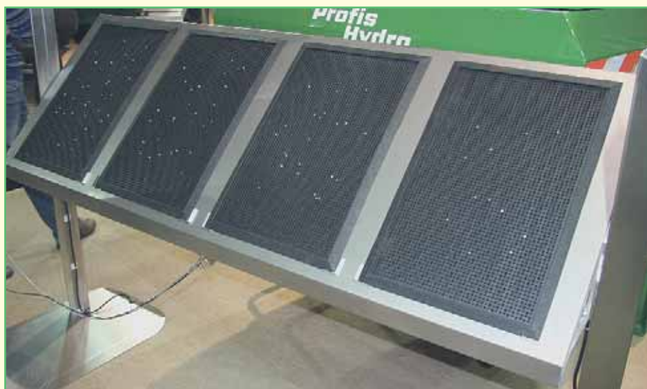
Цифровой мобильный стенд для определения распределения удобрений EasyCheck от AMAZONE
