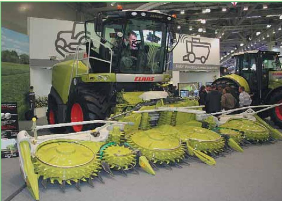
**Фото 4.** Кормоуборочный комбайн JAGUAR 870 с системой DYNAMIC POWER
