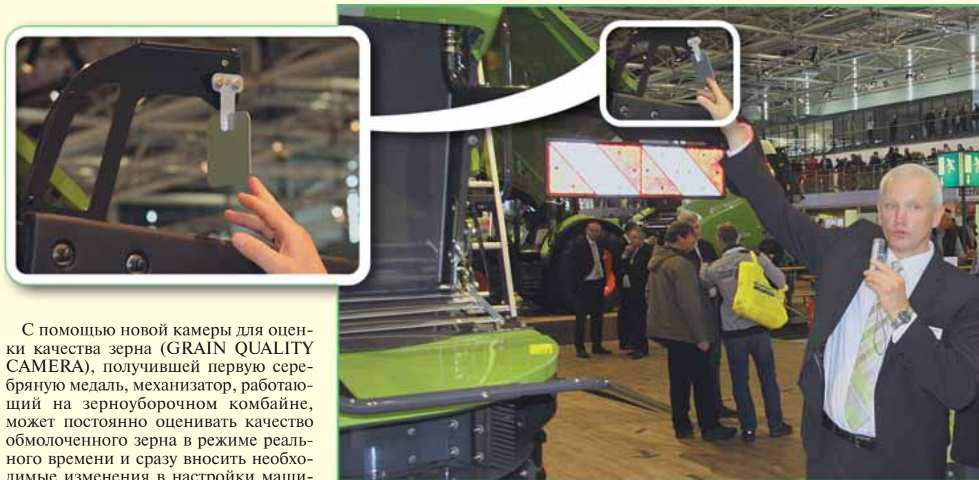
Фото 5. Датчик ветра и уклона на зерноуборочных комбайнах LEXION с радиальным разбрасывателем
