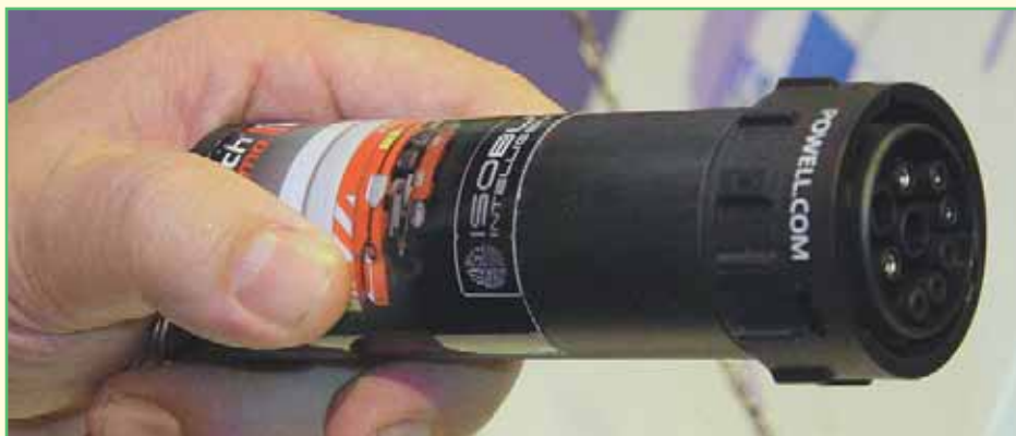
Фото 8. Демонстратор IsoMatch InDemo от Kverneland позволяет изучить работу навесного оборудования без его навешивания в реальности
