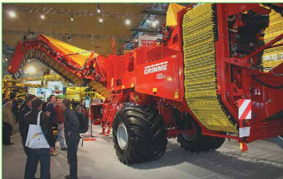
Фото 3. Картофелеуборочный комбайн Grimme с системой AirSep
