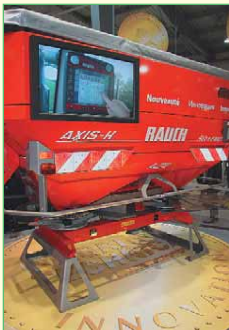
Фото 2. Распределитель удобрений компании RAUCH с системой AXMAT – первой в мире полностью автоматизированной установкой для онлайн-оценки распределения удобрений
