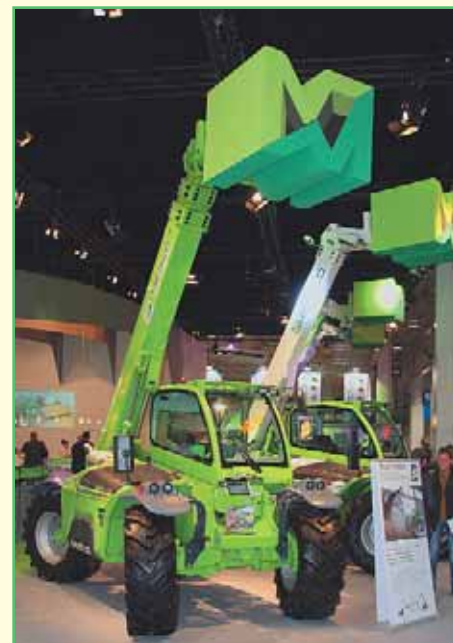
Фото 4. Телескопический погрузчик Merlo с гибридным приводом Merlo Hybrid telehandler
