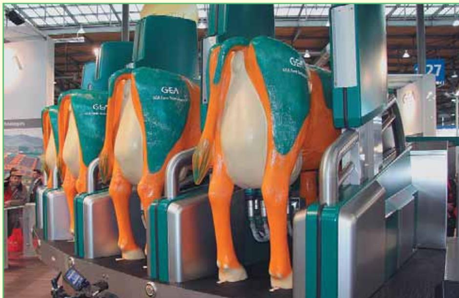
*Узкий модуль GEA DairyProQ позволяет внедрить автоматическое или полуавтоматическое доение при любых уже имеющихся в хозяйстве доильных системах – карусель, тандем, елочка или параллель*
