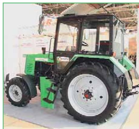
Электротрактор от компании «МОБЭЛ», созданный на базе МТЗ-920
