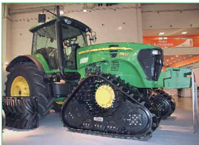
Полугусеничный ход, смонтированный на колесный трактор John Deere 7930
