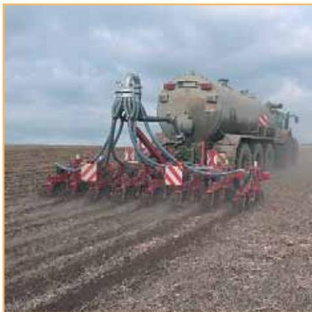
Машины для узкополосной обработки почвы Kultistrip
