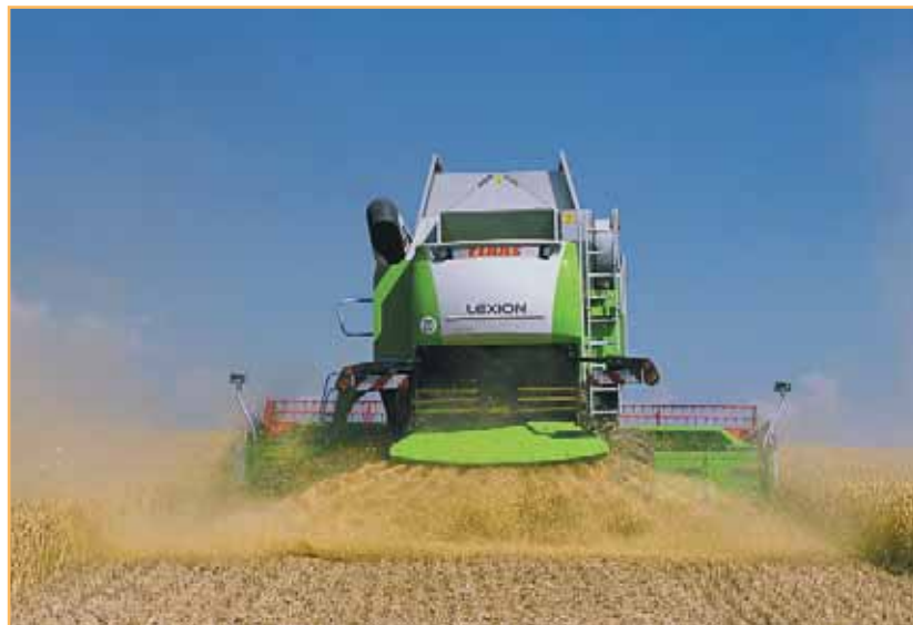
Равномерное распределение соломы по всей рабочей ширине захвата комбайна
