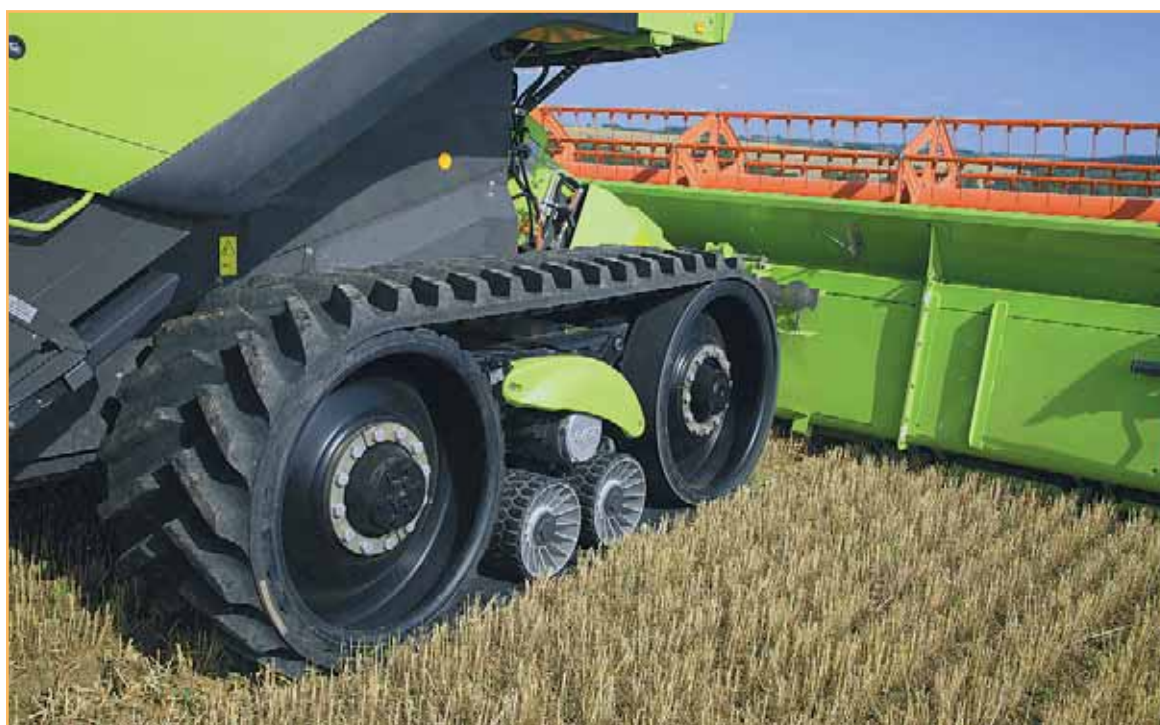
TERRA TRAC (III) с гидропневматической подвеской
