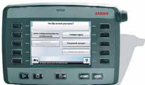
Электронная система оптимизации машины SEMOS от CLAAS выполняет функцию помощника, который определяет нужные настройки комбайна с учетом параметров мощности, качества, безопасности и эффективности.
