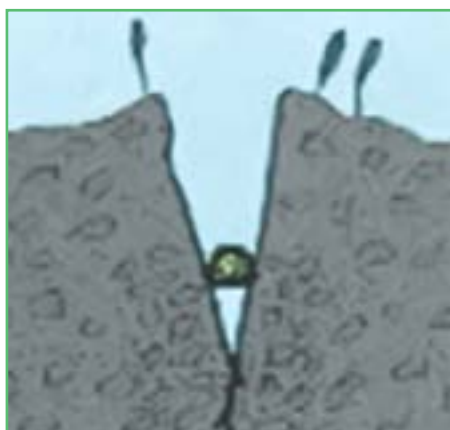
Рис. 2. Борозда в форме V (тип сошника — двойной диск)
