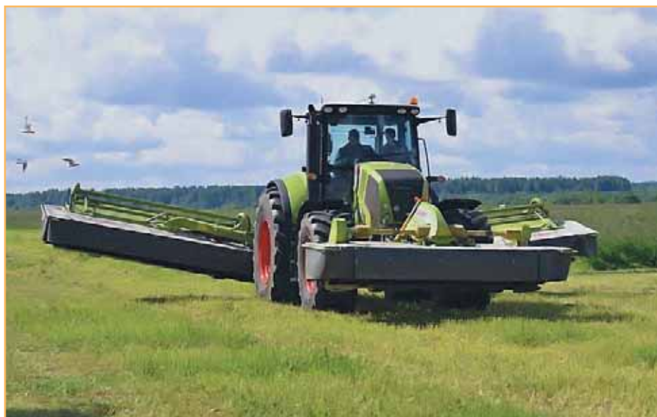
Агрегат из широкозахватной навесной косилки Disco 9100 CAS и фронтальной косилки Disco 3100 FC на базе трактора Axion 850
