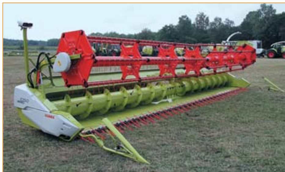
На жатке VARIO 1050 подающий шнек стал больше — теперь его диаметр 660 мм
