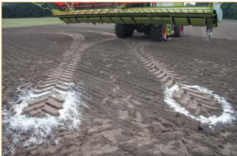
IF-шины серии Ultraflex при предписанной законом транспортной ширине обладают такой же опорной поверхностью и давлением на почву, что и шины большего диаметра. На фото можно увидеть следы от комбайна, правая шина которого — Ultraflex, а левая — обычная. Правый след занимает заметно большую площадь, чем левый
