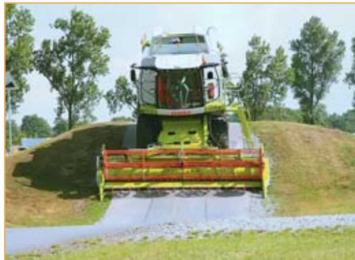
Ходовой механизм LEXION MONTANA компенсирует поперечный наклон до 17% и продольный наклон до 6%
