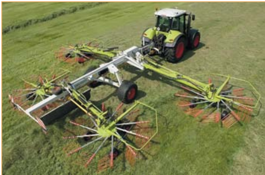
С четырьмя одинаковыми роторами, на которых расположено по 12 граблин, и шириной захвата до 12,50 м LINER 3500 обеспечивает максимальную производительность
