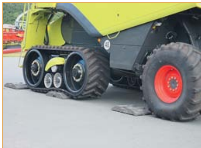
Гусеничная система TERRA TRAC на LEXION 750 позволяет комбайну на трассе развивать скорость до 40 км/ч и при этом обеспечивает великолепную мягкость хода
