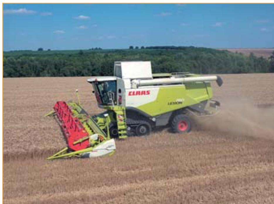
Серия LEXION 700 имеет систему обмолота APS (предварительное ускорение) с отделением остаточного зерна с помощью роторов
