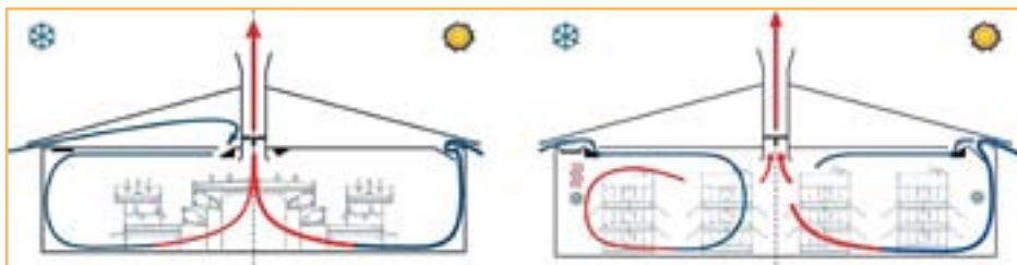
Схема 2. Распределение воздуха в птичнике с вольерным содержанием и птичнике для выращивания молодняка в зимнее и летнее время с использованием потолочных клапанов
