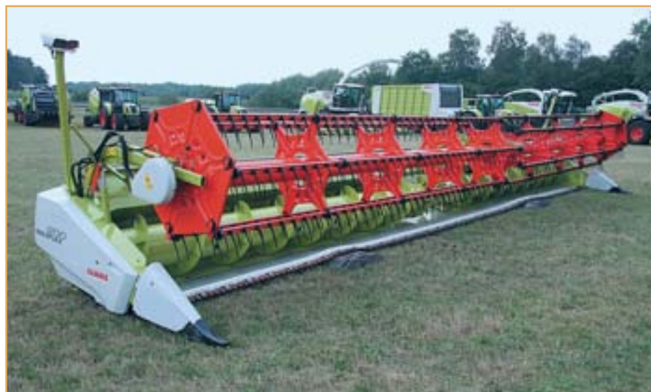
Жатка MAXFLEX оснащена упругим ножевым брусом до 180 мм, который автоматически копирует даже мельчайшие неровности грунта
