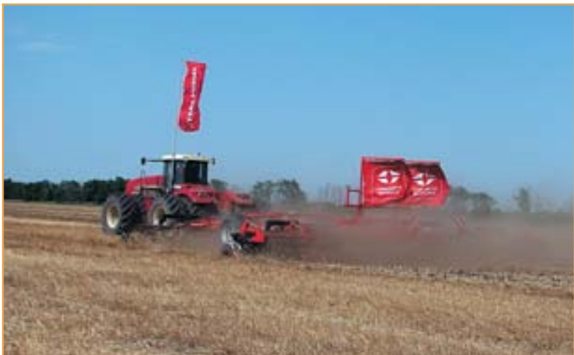
Бороны Gregoire Besson XXL WIDE с шириной захвата 14 метров — новинка компании, требующая особо мощные тракторы
