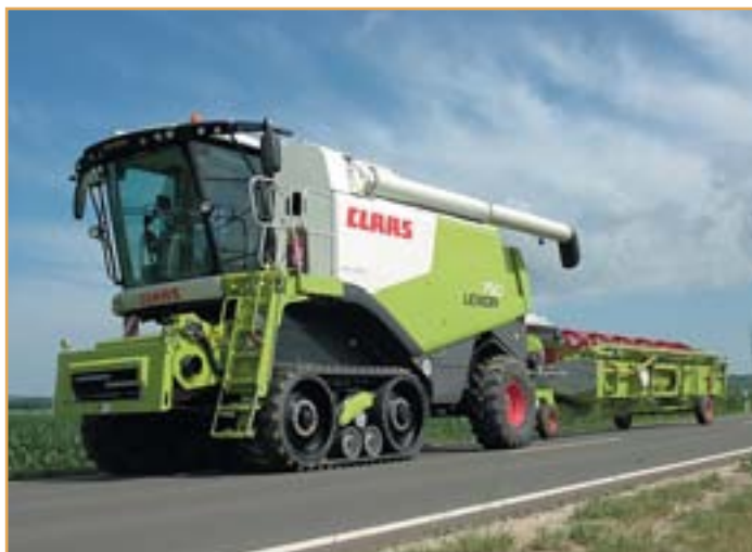
Гусеничная система TERRA TRAC на LEXION 750 позволяет комбайну на трассе развивать скорость до 40 км/ч и при этом обеспечивает великолепную мягкость хода
