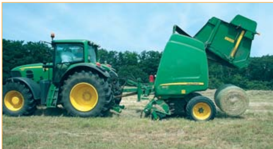
Фото 3. Если раньше для формирования рулона сена от оператора требовалось произвести четыре действия, то с системой ISOBUS — только одно: начать движение
