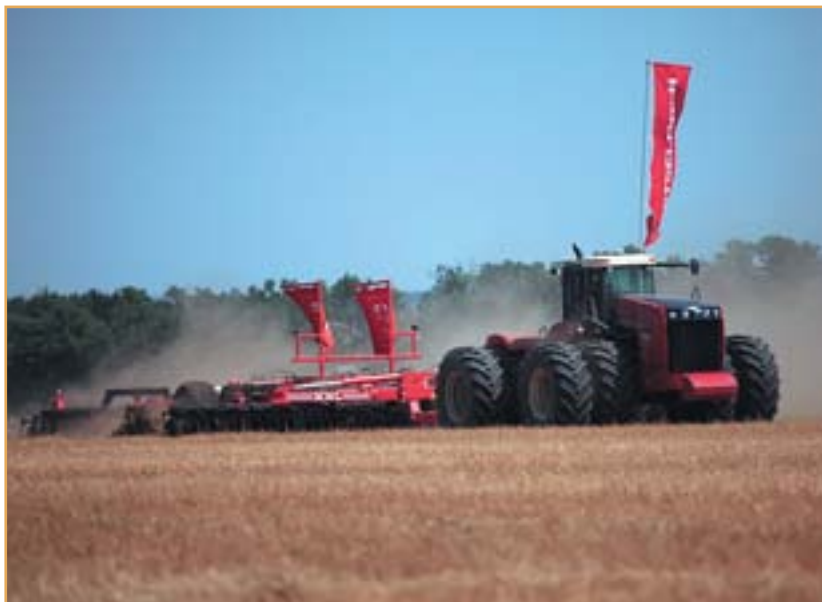
В установлении рекорда принимал участие трактор VERSATILE серии ННТ мощностью 535 л.с. – самый мощный трактор в продуктовой линейке компании Buhler Industries Inc.
