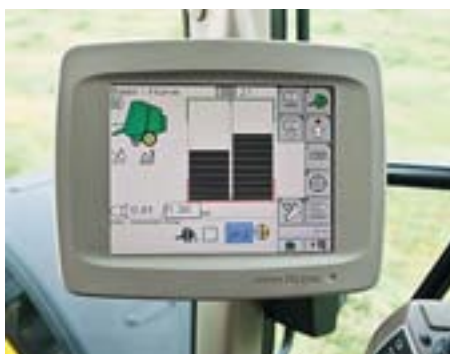
Фото 4. Дисплей, которым оборудована кабина трактора John Deere, для получения информации о работе пресс-подборщика
