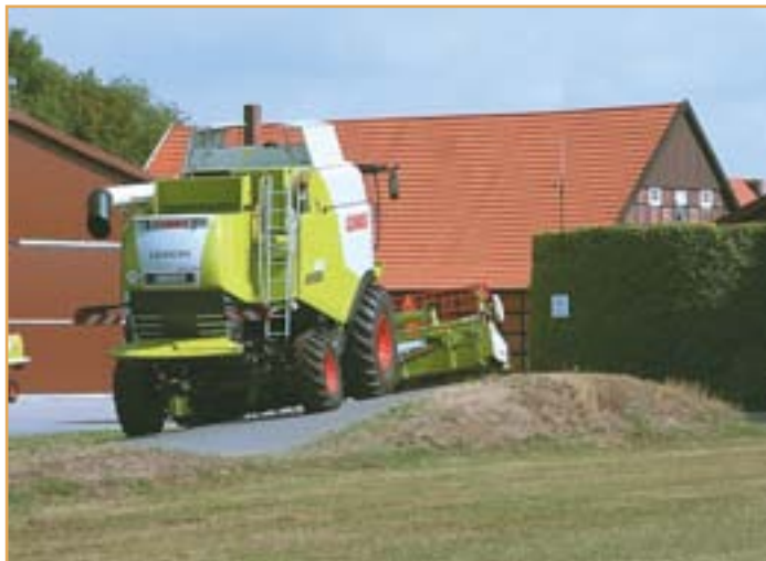
Ходовой механизм LEXION MONTANA компенсирует поперечный наклон до 17% и продольный наклон до 6%
