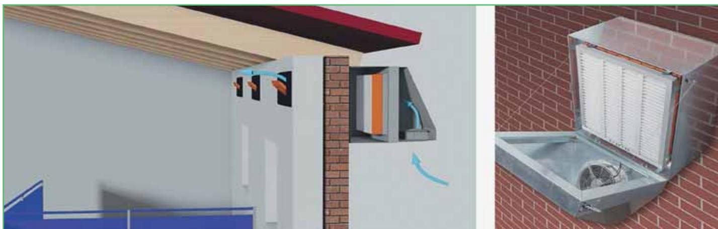
**Рис. 2.** Схема работы АРТ 1500 для подачи отфильтрованного воздуха через стенной клапан СЛ 1200
