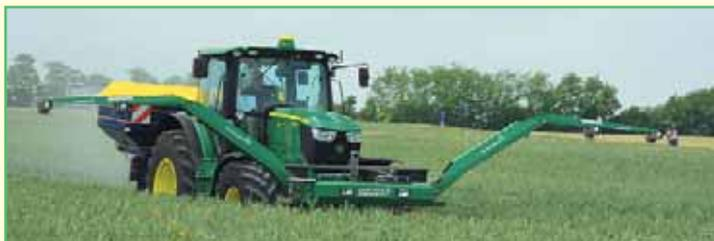
*В работе – разбрасыватели удобрений. Тракторы оборудованы различного типа датчиками, по цвету растений определяющими потребность в азоте каждого конкретного участка поля.*
