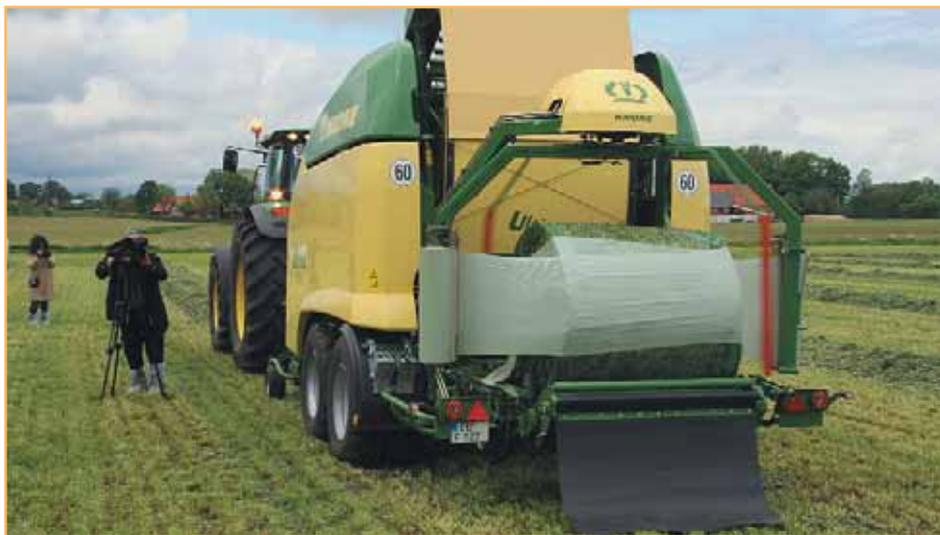
*Рулонный пресс-подборщик с обмотчиком Ultima CF 155 XC на ходу обматывает рулон и одновременно формирует следующий*
