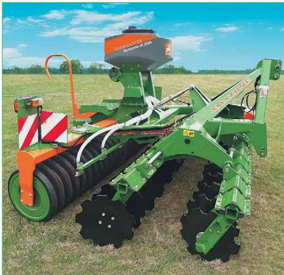
Высевающее приспособление GreenDrill от Amazone может быть навешено на различные почвообрабатывающие орудия Amazone с шириной захвата до 4 м
