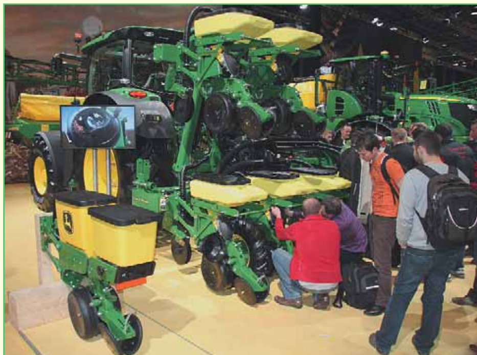
Фото 1. Получившая золотую медаль высокоскоростная пневматическая сеялка точного высева ExactEmerge от компании John Deere пользовалась особым вниманием посетителей выставки SIMA-2015
