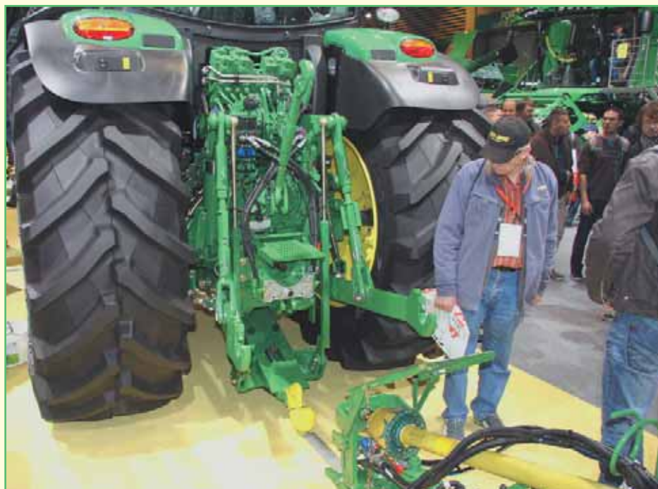
Фото 2. Система автоматического подсоединения к трактору прицепного оборудования AutoConnect от компании John Deere
