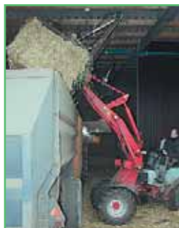
Изобретение фермера Боне: погрузчик подцепляет тюк соломы за жгуты сверху — раз; отвозит его к смесителю-измельчителю — два; срабатывает режущий механизм, тюк падает вниз, а жгуты остаются на штырях погрузчика — три
