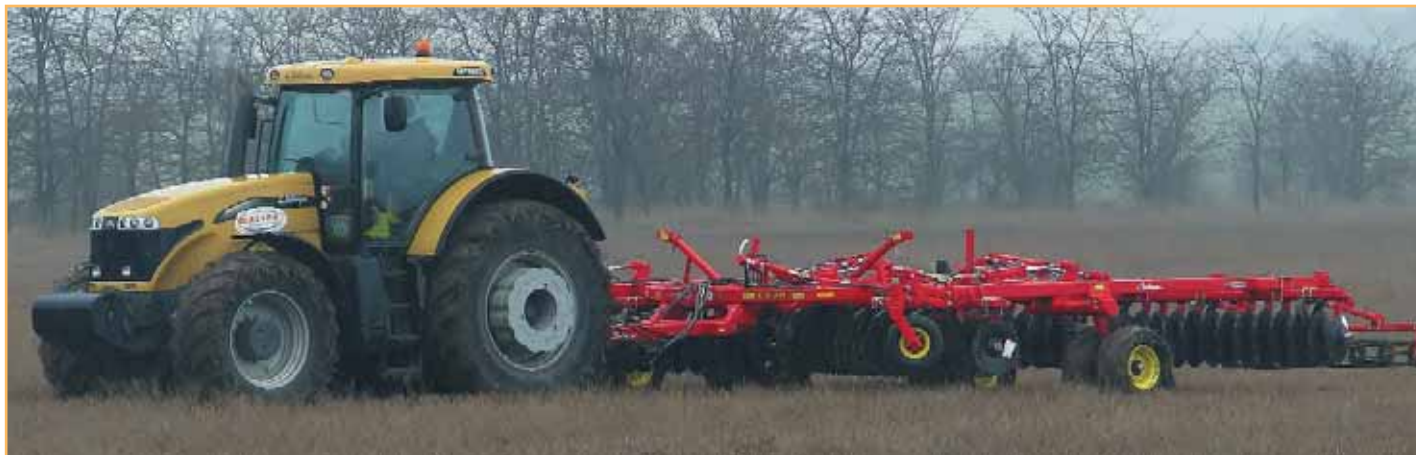
Фото 2. Культиватор для «вертикальной» обработки Challenger CH 6630-27
