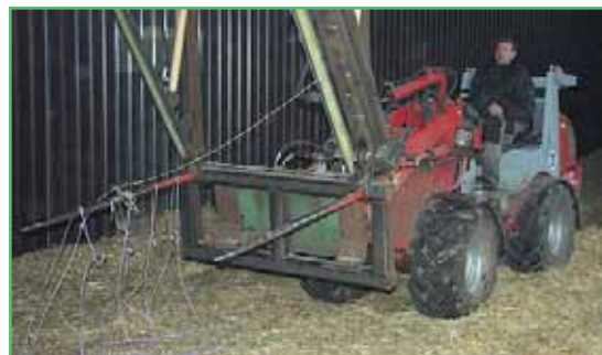
Изобретение фермера Боне: погрузчик подцепляет тюк соломы за жгуты сверху — раз; отвозит его к смесителю-измельчителю — два; срабатывает режущий механизм, тюк падает вниз, а жгуты остаются на штырях погрузчика — три
