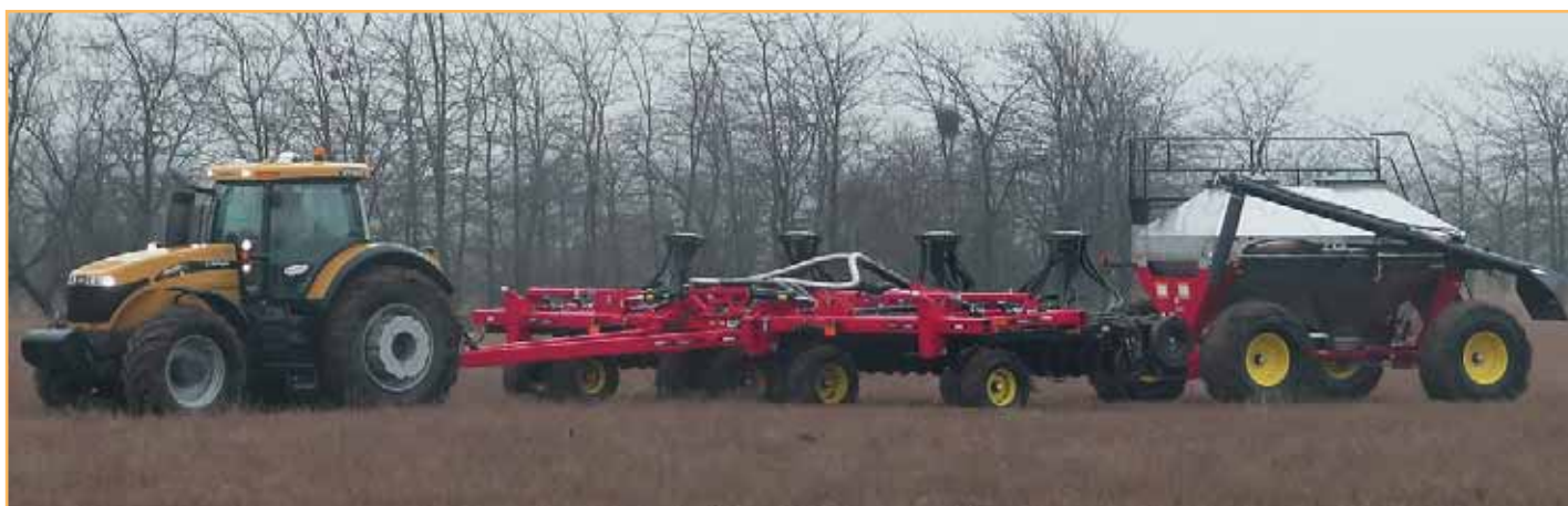
Фото 3. Пневматическая сеялка Challenger CH 9830-40 с бункером CH 9920-280
