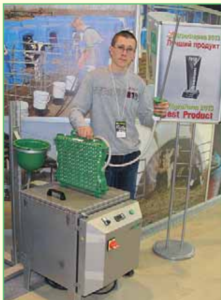
Система выйки телят первым молозивом soloQUICK от Holm & Laue GmbH & Co. KG. Зонд, который показывает сотрудник компании «Иглус», при необходимости может быть помещен непосредственно в желудок теленка
