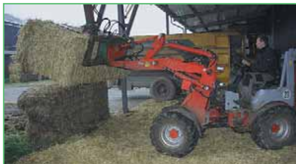
Изобретение фермера Боне: погрузчик подцепляет тюк соломы за жгуты сверху — раз; отвозит его к смесителю-измельчителю — два; срабатывает режущий механизм, тюк падает вниз, а жгуты остаются на штырях погрузчика — три
