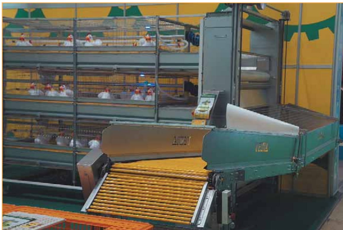
Роботизированная система выгрузки птицы компании ТЕХНА
