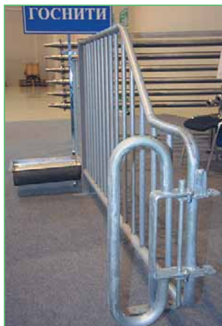
Станок для безвыгульного индивидуального содержания свиноматок в отделении осеменения производства Рязанского опытного завода
