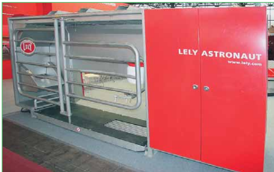
Стойло с мягким резиновым полом роботизированной доильной системы Astronaut производства компании Lely
