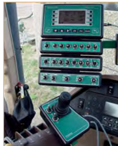
Кабина водителя оборудована компьютерами, которые контролируют весь рабочий процесс
