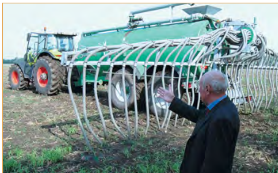
Цистерна в работе — Россия, Краснодарский край. Использование различных насадок помогает интенсифицировать процесс внесения удобрений
